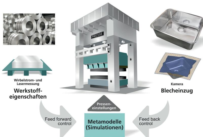
**Inline-Prozessregelung:** Ein Regelalgorithmus, der auf AutoForm-Sigma basiert, berechnet, wie Pressenkräfte und deren Verteilung anzupassen sind, um den Blecheinzug wieder auf seinen Sollwert zu bringen. (© AutoForm/IVP/Franke)
