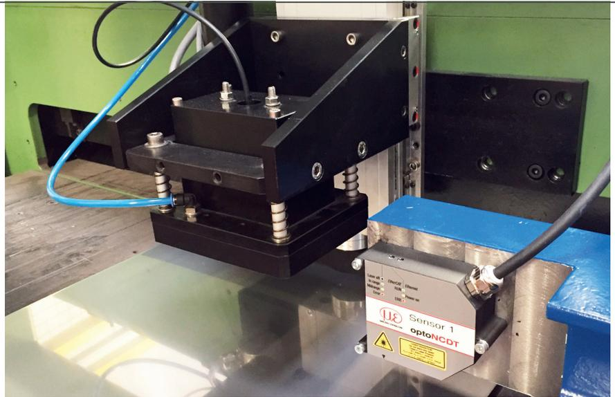
**Analyse im Prozess:** An der Platinenschneidanlage ist das Wirbelstrommessgerät sowie das Lasermesssystem installiert, mit denen die Materialeigenschaften und die Blechdicke erfasst werden. (© AutoForm/IVP/Franke)
